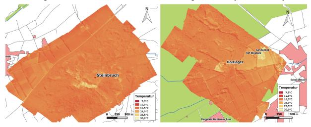
Abb. 6: Thermale Testbefliegung: Gebiet um einen Steinbruch (93 Einzelbilder, links) und ein Waldgebiet mit Nasslager (89 Einzelbilder, rechts) bei Schmidtheim (Eifel).
