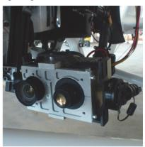
Abb. 2: Im Tragschrauber eingebaute Bildsensorik: Nikon D800e (links); Cubert UHD 285 Hyperspektralkamera (mittig); PANTIR Thermal Imager (rechts).
