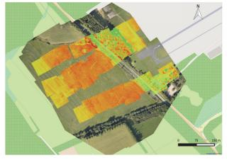
Abb. 4: Matching von hyperspektralen Einzelaufnahmen auf einem VIS-RGB-Orthomosaik in dem Geoinformationssystem QGIS (http://www.ggis.org).
