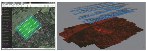
Abb. 5: Thermale Testbefliegung: Gebiet um einen Steinbruch bei Dahlem; Flugplanung (links); Berechnung des Orthomosaik mit PhotoScan (rechts).
